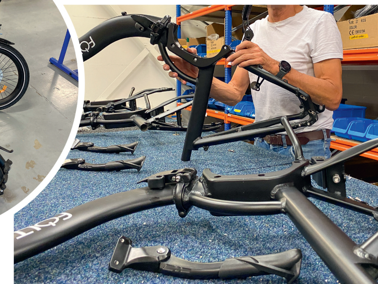
Aluminium frame check door een monteur
